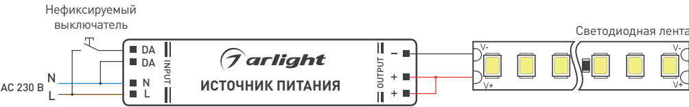
Рис. 2. Подключение источника питания при управлении нефиксируемым выключателем (управление Push-Dim)
