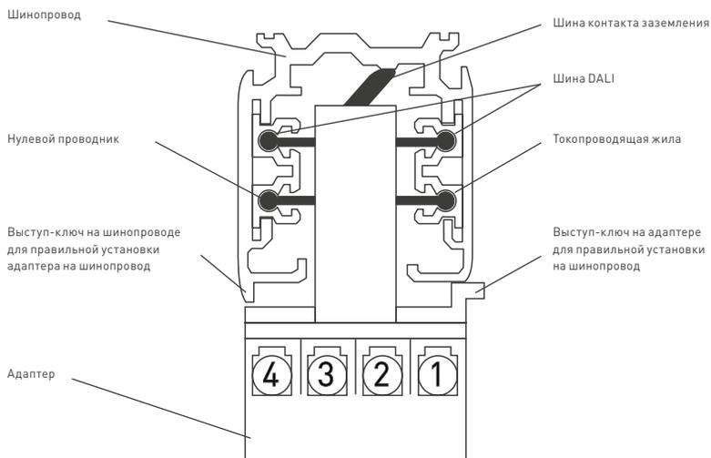
Рис. 5. Подключение адаптера к шинопроводу
