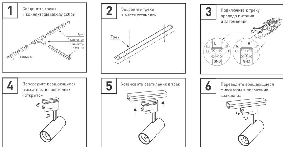
Рис. 7. Установка и подключение светильника
