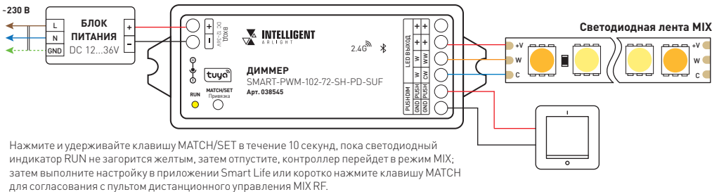
Рис. 2. Подключение MIX-ленты
