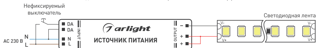
Рис. 2. Подключение источника питания при управлении нефиксируемым выключателем (управление Push-Dim)
